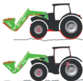
Încărcătorul frontal cu sistem de amortizare
